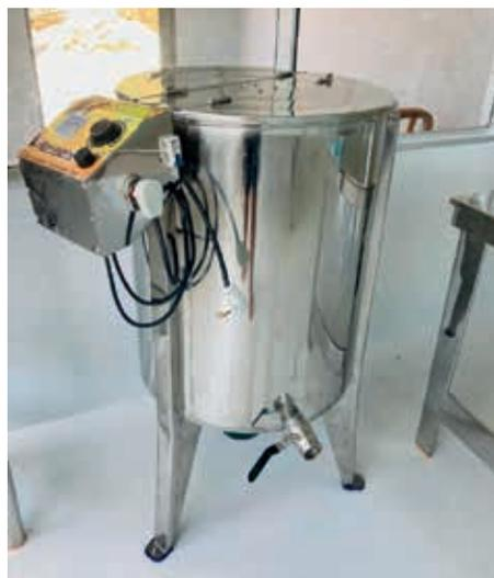
**Figura 9** – Centrifuga radial - Fonte: Natália Abreu Serra – Apiário Âmbar
