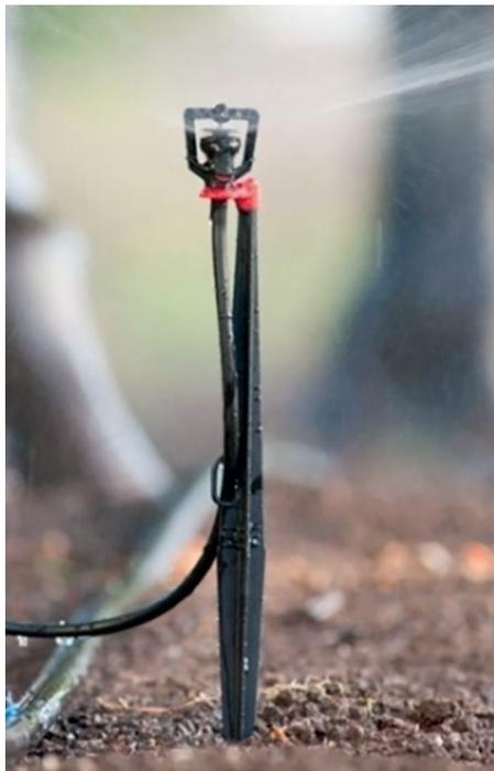
Figura 37: Microaspoersor móvel com bailarina em funcionamentos. (Fonte: Google)
