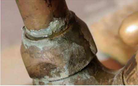
Figura 10: Conexão com a presença de calcificação (Fonte: Google)
