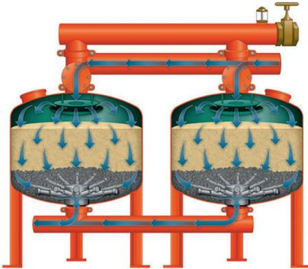
Figura 30: Funcionamento de um filtro de areia. (Fonte: Google)
