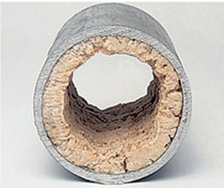
Figura 11: Secção de uma tubulação com acúmulo de calcário. (Fonte: Manual de Irrigação – UFV)
