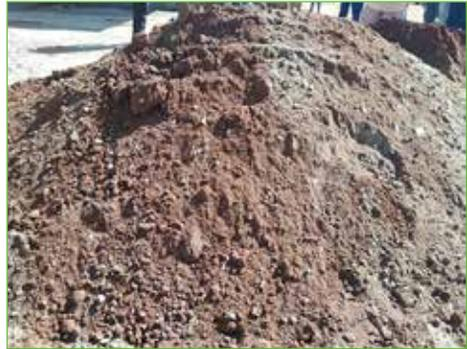
**Figura 53.** Mistura de material para conformação do leito. Proporção 2:1.
