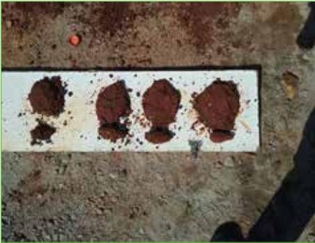
**Figura 52.** Mistura manual para análise da proporção ideal. Da esquerda para direita: 1,5:1,0 – 2,0:1,0 – 2,5:1,0 e 3,0:1,0.
